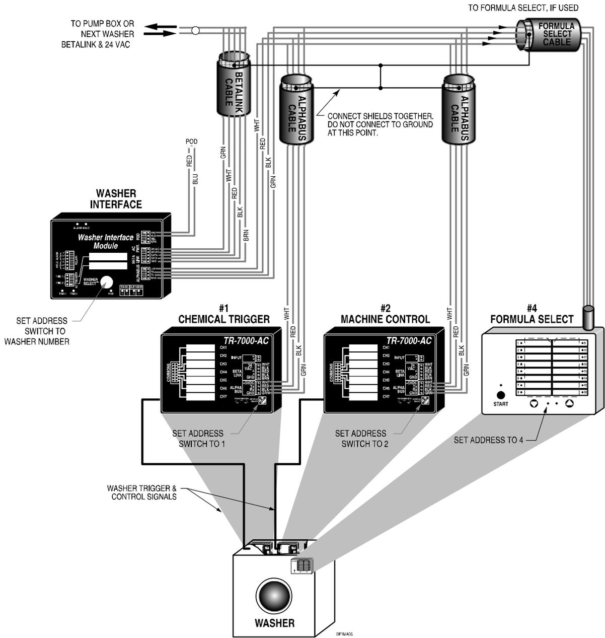
Figure 30. ILS Max Emulation Wiring
